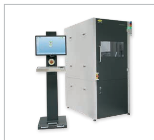
EVG*810 LT LowTemp™ プラズマ活性化装置 300mmまでの基板に対応
