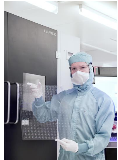
写真: バイオテクノロジーと医療デバイスを大型基板上で並列処理を可能にしたEVG®7200全自動UVベースのナノインプリントリソグラフィ(UV-NIL)装置
