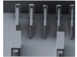
90°の側壁角度を持つ80  $\mu\text{m}$ 厚のSU-8レジスト構造
