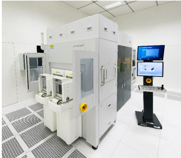
圖一_ EV Group 的 LITHOSCALE® 無光罩曝光系統將數位化曝光的優勢帶至產品量產中。
